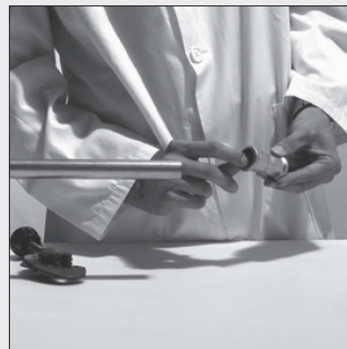
Rys. 21 Sprawdzenie obecności i pozycji o-ringa w kilichu złączki
