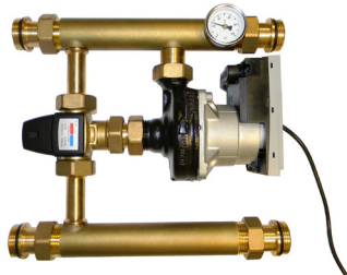
Moduł mieszający – zestaw do montażu pomiędzy rozdzielaczem ogrzewania grzejnikowego i rozdzielaczem ogrzewania płaszczyznowego
