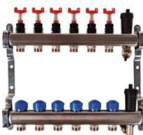
KRIPT – Rozdzielacz 1" do ogrzewań płaszczyznowych i grzejnikowych z wyjściem do złączek G 3/4" o standardzie Eurokonus z automatycznymi odpowietrznikami – belki ze stali nierdzewnej
