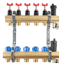
KRPTp – Rozdzielacz 1" do ogrzewań płaszczyznowych i grzejnikowych z wyjściem do złączek G 3/4" o standardzie Eurokonus z automatycznymi odpowietrznikami
