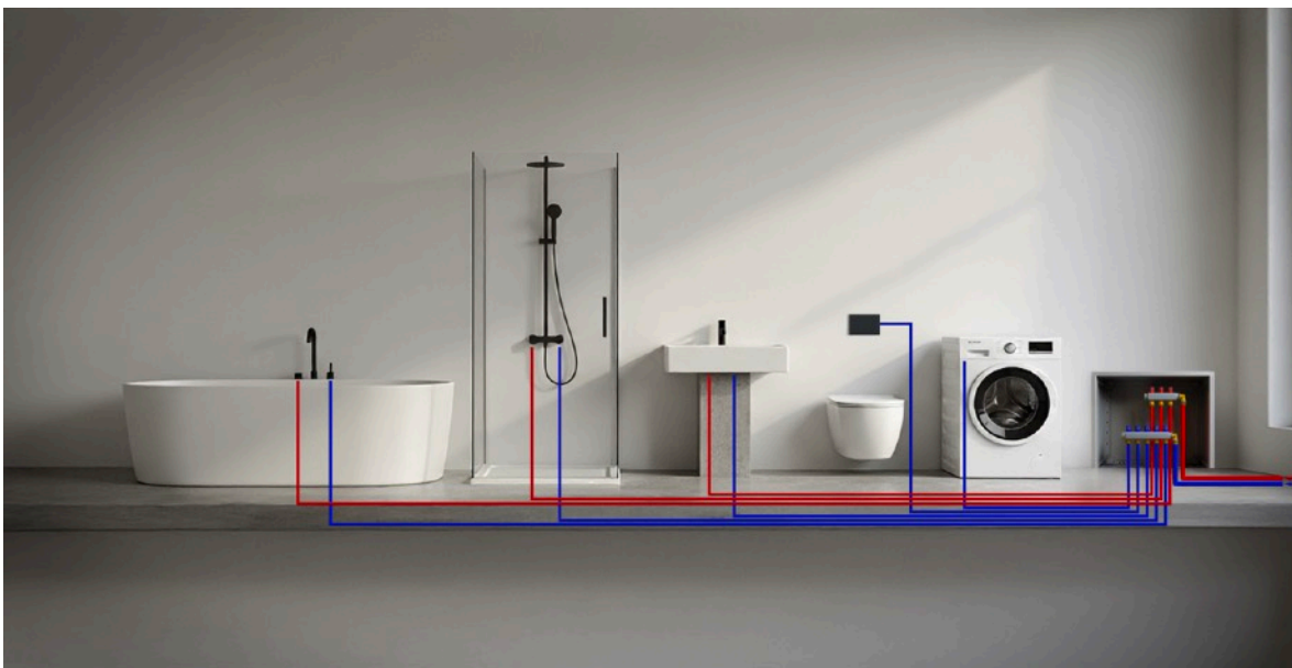
Schemat instalacji wody ciepłej i zimnej, w systemie KISAN® Safe Water Connection bez cyrkulacji
