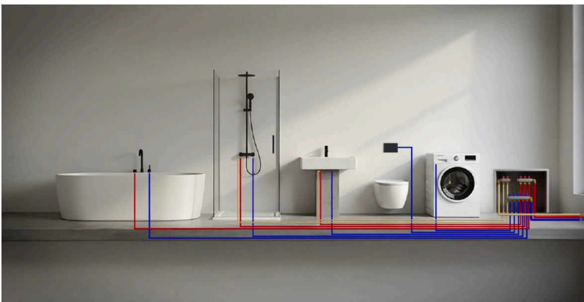
Schemat instalacji wody ciepłej i zimnej w systemie KISAN® Safe Water Connection z rozdzielaczem cyrkulacyjnym
